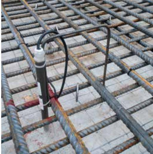
Korrosionssensor »Anodenleiter« zum Überwachen des zeitabhängigen Eindringens von Chloriden bzw. der Carbonatisierungsfront in den Beton
